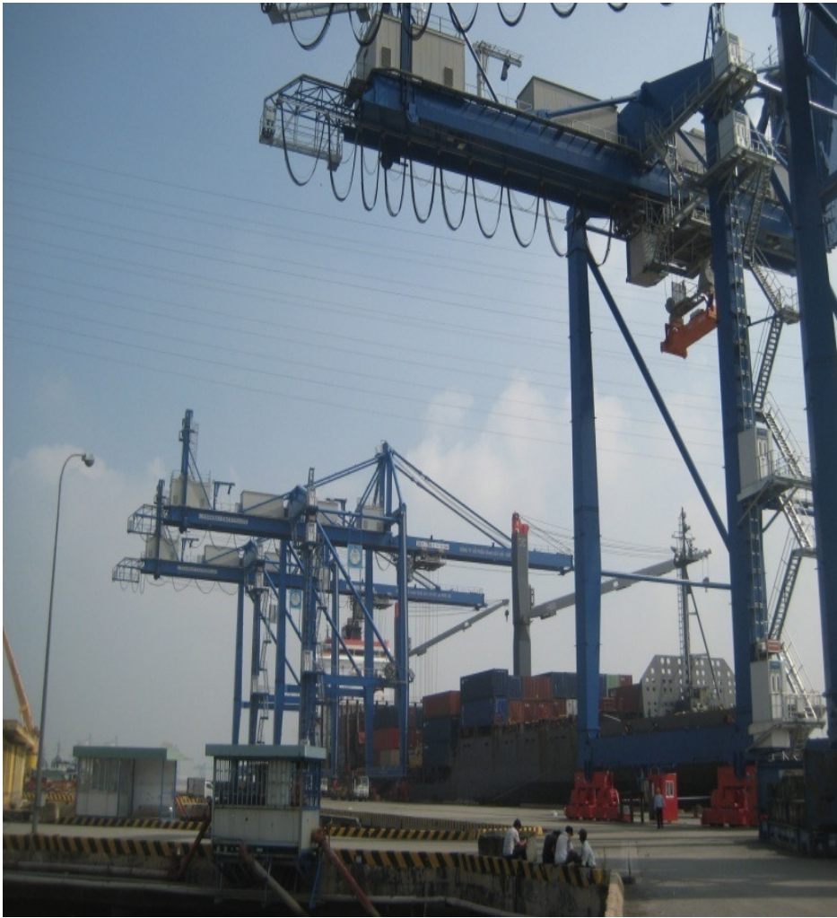
Cầu container dạng khung chạy trên ray hiệu K.E làm hàng tại cầu tàu
