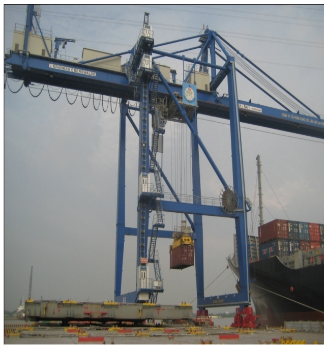
Thiết bị xếp dỡ cầu KE làm hàng tại cầu tàu
